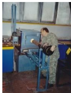
První pec s vodíkovým generátorem vyrobeným ze sušiče na vlasy
